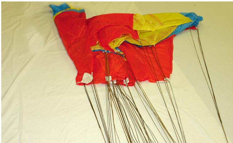
Рисунок 44 – Укладка задней части купола
