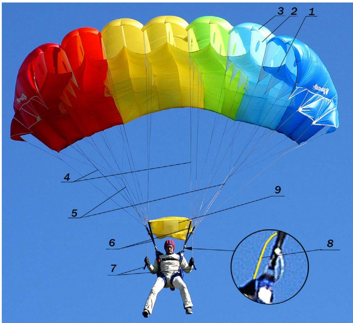
1 – полотнище нижнее; 2 – нервюра; 3 – полотнище верхнее; 4 – стропы; 5 – стропы управления; 6 – концы свободные; 7 – звенья управления; 8 – звено разблокировки прибора; 9 – устройство рифления.
