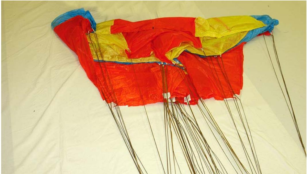
Рисунок 43 – Укладка задней части купола
