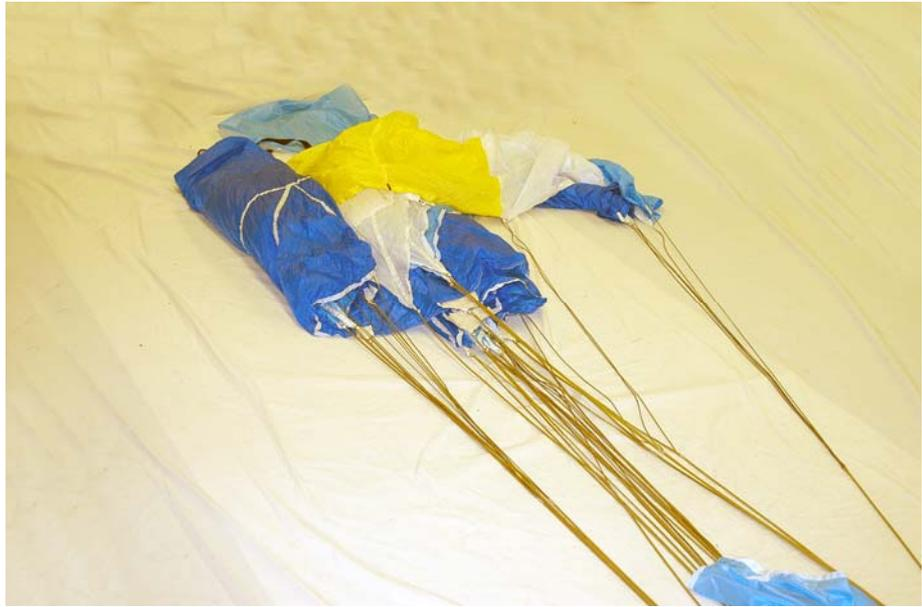
Рисунок 90 – Укладка задней части купола
