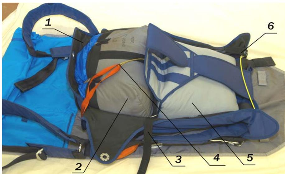
1 – ранец; 2 – камера; 3 – звено парашютное; 4 – петля зачековочная с затяжкой; 5 – запасной парашют, уложенный в ранец; 6 – левый свободный конец.
