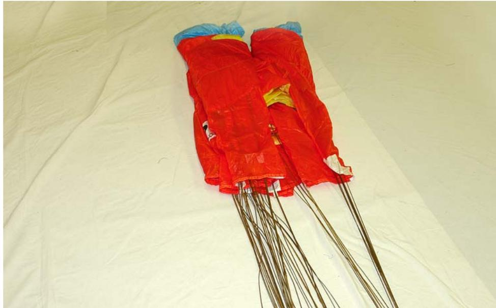
Рисунок 47 – Укладка задней части купола
