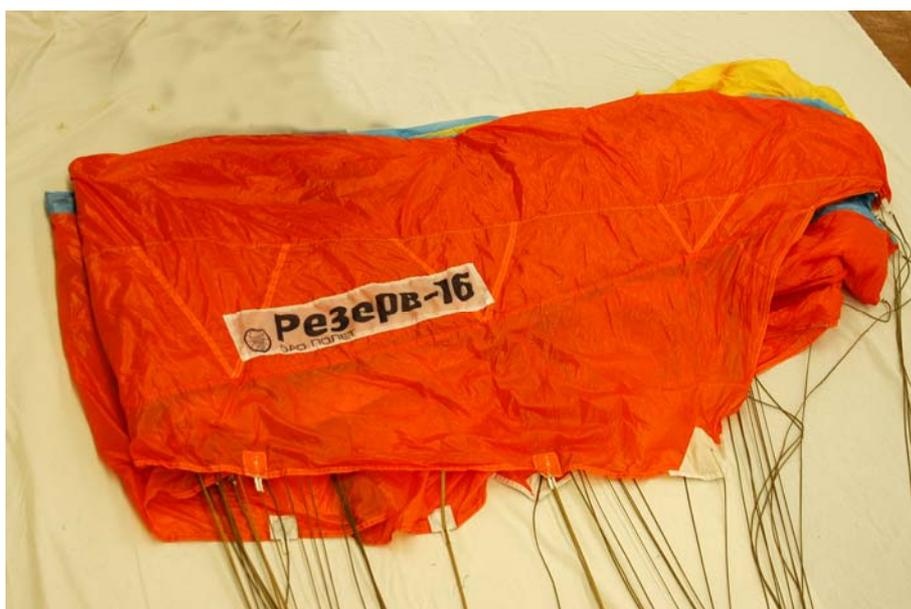
Рисунок 38 – Укладка передней части купола
