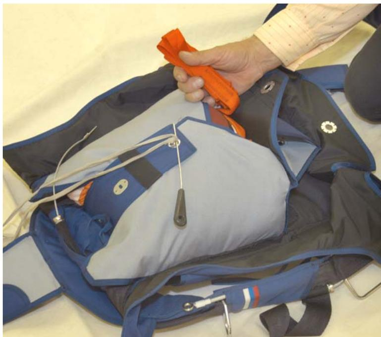
Рисунок 69 – Укладка звена парашютного
