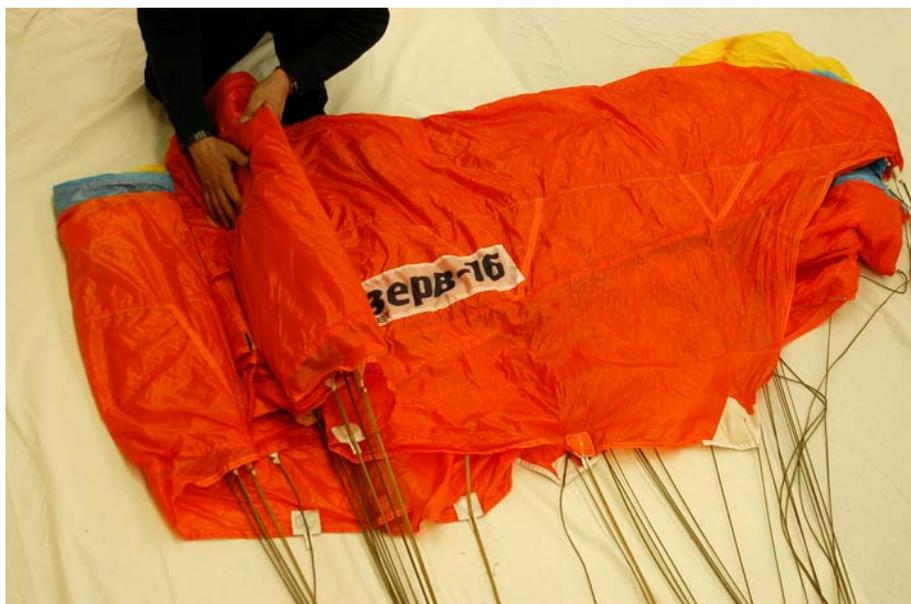
Рисунок 37 - Укладка передней части купола
