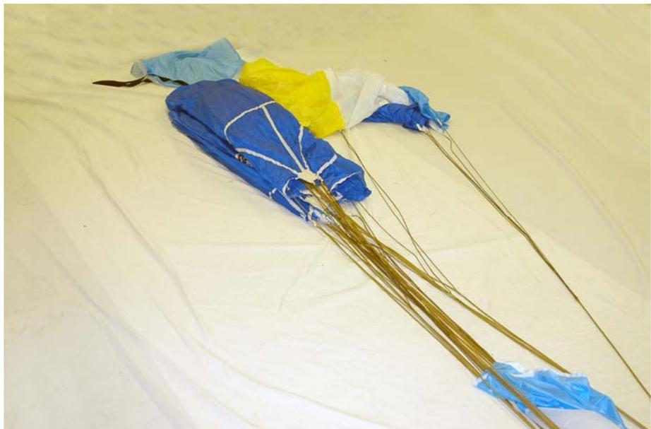
Рисунок 91 - Укладка задней части купола
