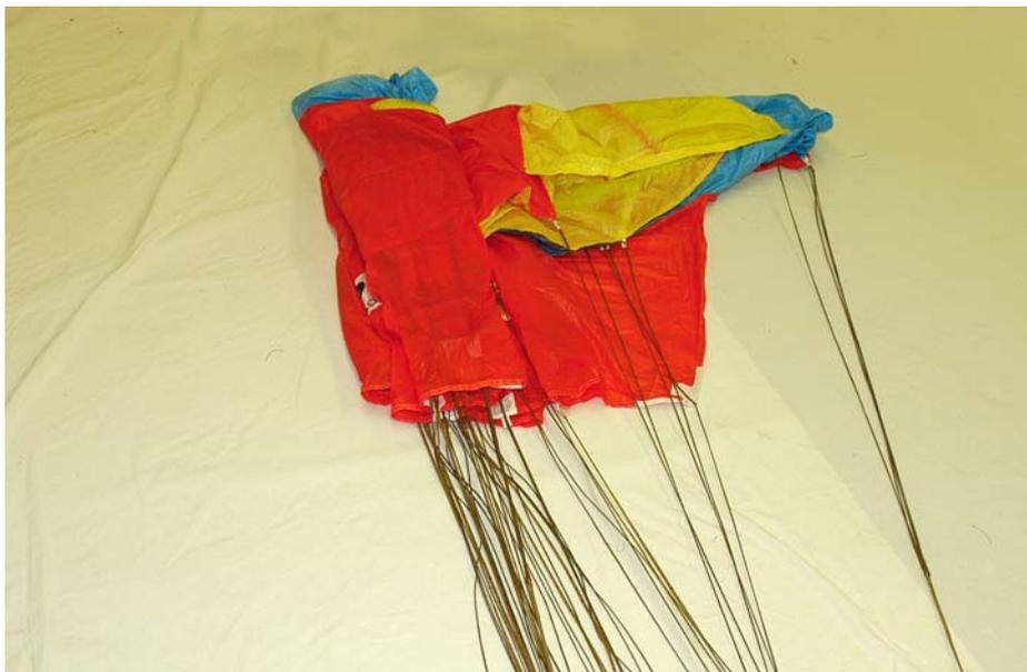
Рисунок 45 - Укладка задней части купола
