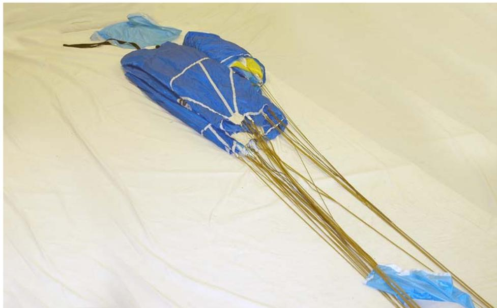
Рисунок 93 - Укладка задней части купола
