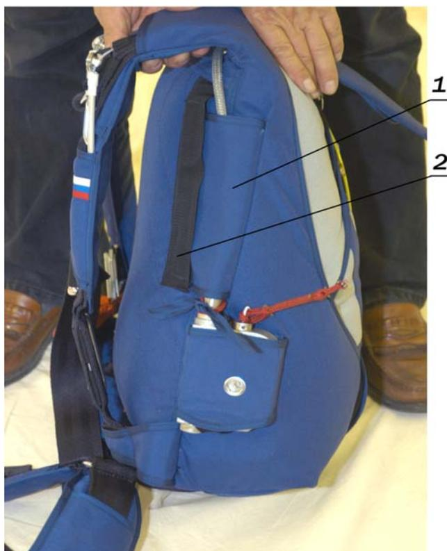
1 – клапан предохранительный; 2 – лента с текстильной застежкой.
