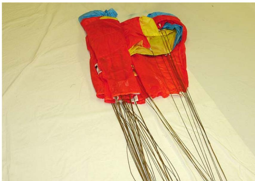
Рисунок 46 - Укладка задней части купола
