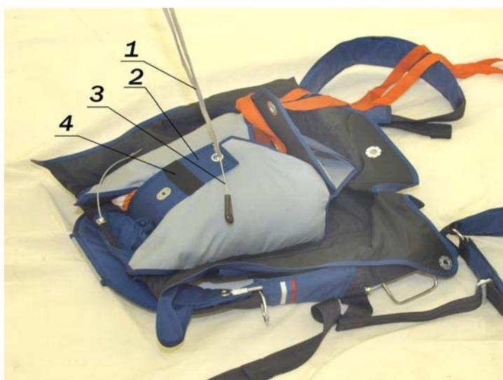
1 – затяжка; 2 – клапан верхний; 3 – шпилька укладочная; 4 – шлевка эластичная.
