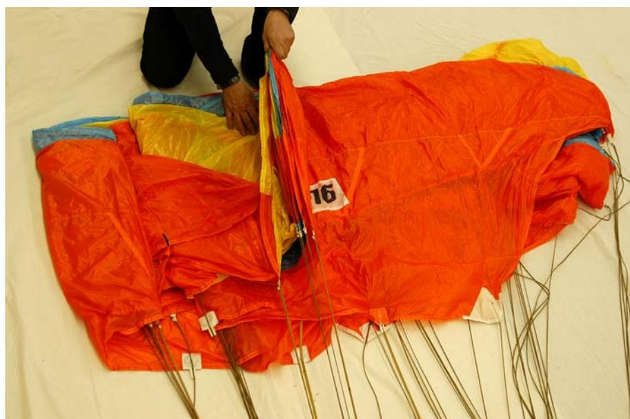
Рисунок 36 - Укладка передней части купола
