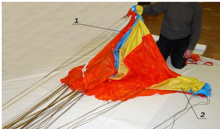
1 – первая половина задней части купола; 2 – вторая половина задней части купола.
