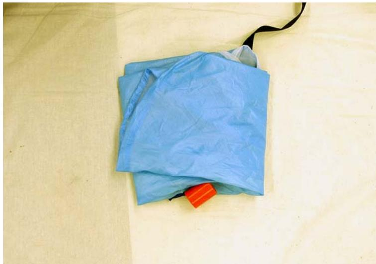
Рисунок 116 - Укладка вытяжного парашюта
