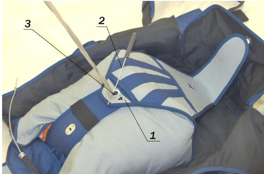
1 – клапан ранца с маркировкой «4»; 2 – шпилька укладочная; 3 – петля.
