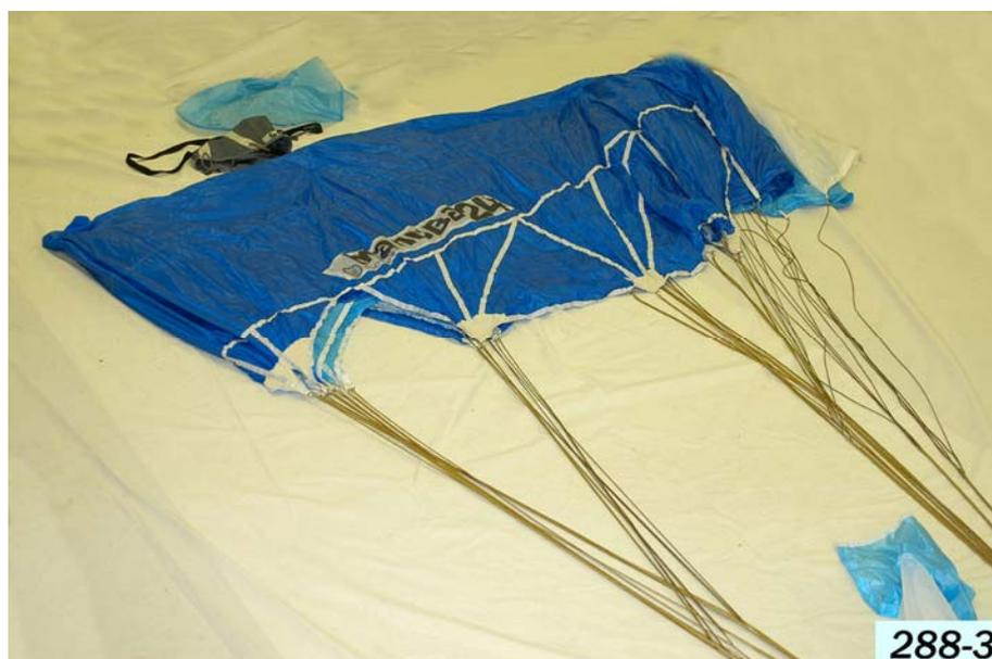
Рисунок 85 – Укладка передней части купола
