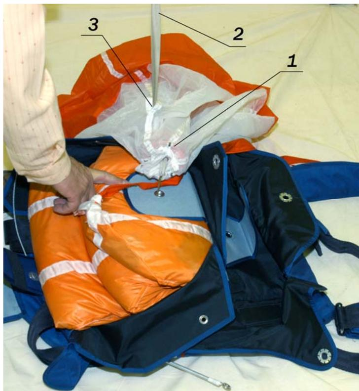
1 – конус вытяжного парашюта; 2 – длинная затяжка; 3 – боковое отверстие.
